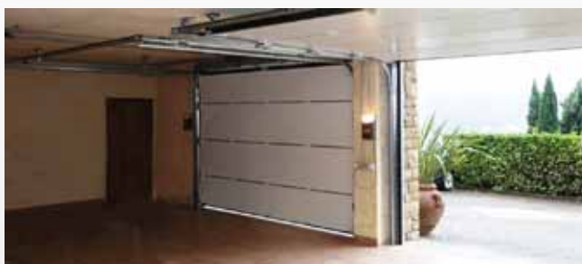
Portoni di grandi dimensioni, maggiori di L=5.050 mm., vengono rinforzati con profili in acciaio zincati, cassette maggiorate e portarotelle doppi.
