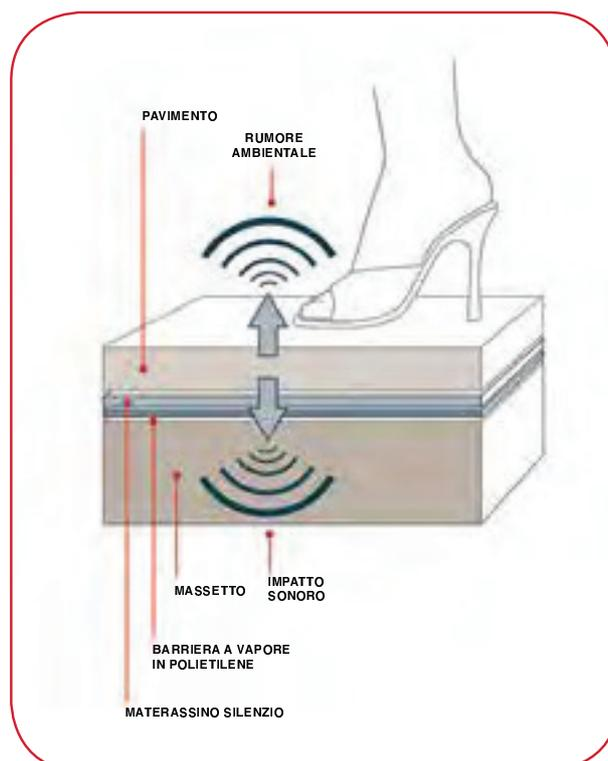
Con stesura obbligatoria sul massetto di una barriera al vapore che trattiene l'umidità di risalita.
