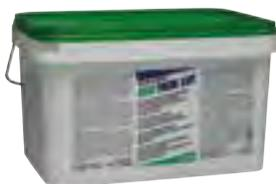
Adesivo a base di resine acriliche in dispersione acquosa ad appiccicosità permanente e a spalmatura semplice, ma con fissaggio removibile per pavimentazioni LVT e autoposanti. Buona resistenza all'umidità. Temperatura di applicazione: da +15° a +35°C. Adatto per riscaldamento a pavimento.
